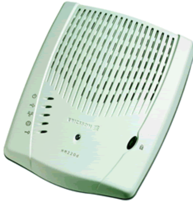
Figura 34. Módem para conexión ADSL.
